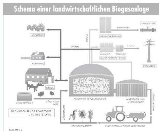
Abbildung 1: Verfahrensschema einer Biogasanlage 7
